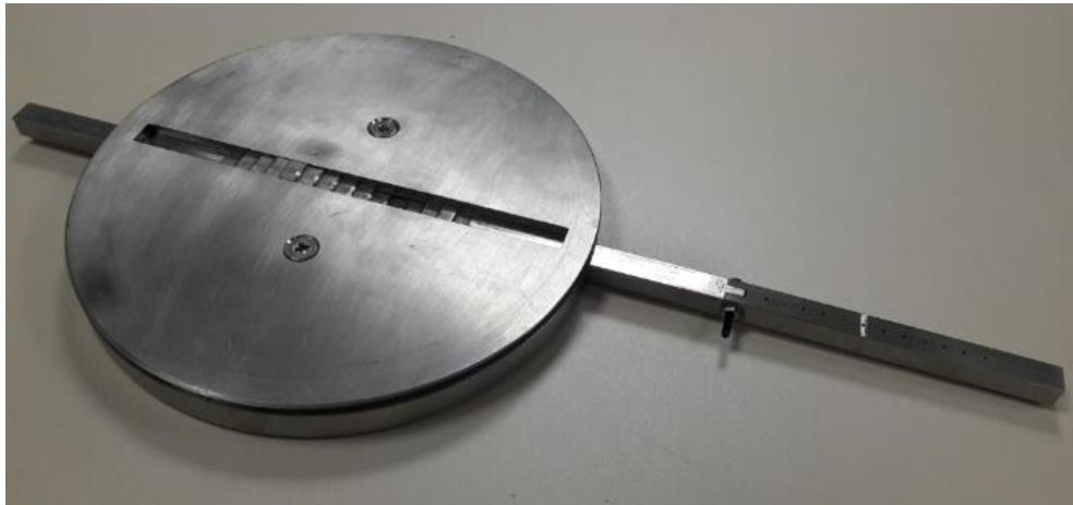
Figure 77 : Montage d'étalonnage des LVDT à température ambiante et à chaud
