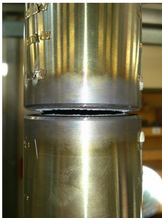
Figure 114: Rupture de l'éprouvette "PROFATH" n°2 par post-fissuration par fatigue.
