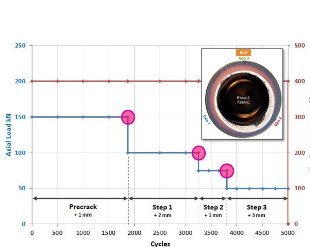
Figure 118 : Chargements appliqués et mesure des complaisances durant l'essai « PROFATH » n°4
