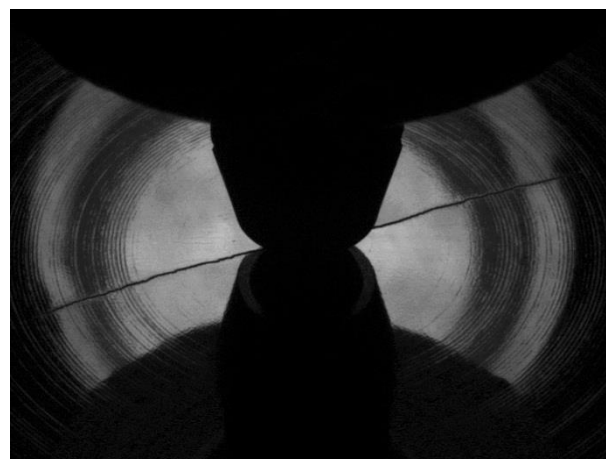
Figure 42 : Image issue de la caméra 2 (face 2), propagation finale à 22000 cycles
