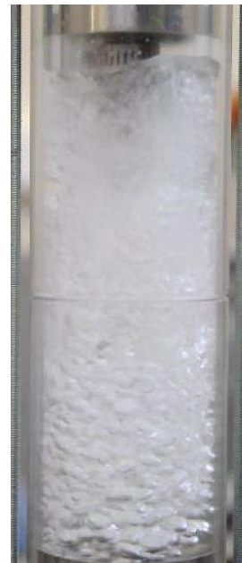
Figure 111 : Evolution de la turbulence après 10 secondes d'injection pour la buse « rotative »
