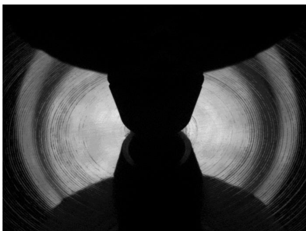
Figure 39 : Image issue de la camera 1 (face 1), première détection d'amorçage de fissure à 16500 cycles
