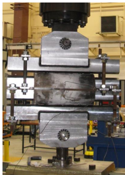
Figure 88: Banc d'essai mécanique utilisé pour le marquage mécanique de la propagation de fissure
