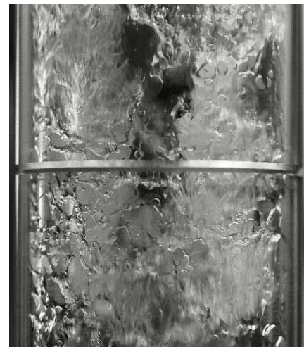
Figure 109 : Début de l'injection (avant remplissage) avec la buse « rotative », présence de surfaces « sèches »
