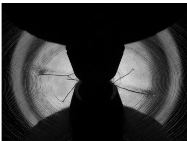
Figure 41 : Image issue de la camera 1 (face 1), propagation finale à 22000 cycles
