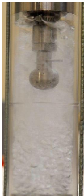
Figure 110 : Evolution de la turbulence après 5 secondes d'injection pour la buse « fixe »
