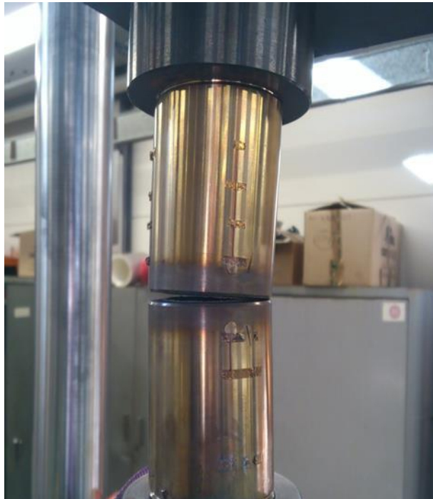
Figure 114: Rupture de l'éprouvette "PROFATH" n°2 par post-fissuration par fatigue.
