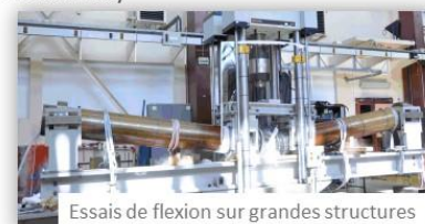
Essais de flexion sur grandes structures
