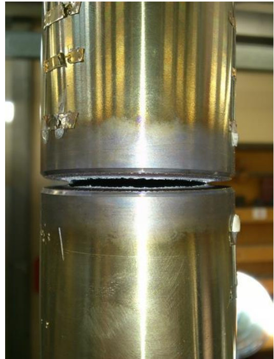
Figure 114: Rupture de l'éprouvette "PROFATH" n°2 par post-fissuration par fatigue.
