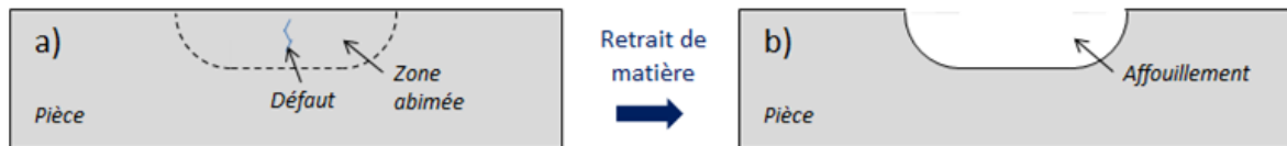
Figure 2.6 : a) pièce plane présentant un défaut affleurant à la surface, b) affouillement obtenu après creusement autour du défaut (cas où la totalité du défaut a été retirée).
