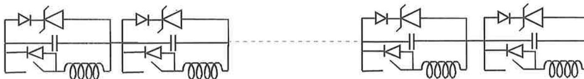
Figure III-6 : Interrupteur quasi résonnant haute tension avec inductance et capacité répartie.
