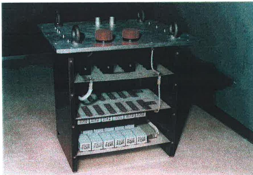
Figure IV-20 : Diode de roue libre et capacités de découplage.
