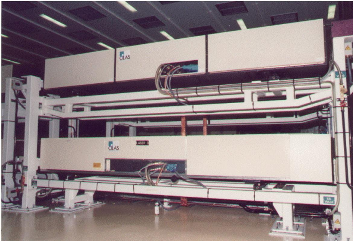
*Figure V.2 : lasers MNT100 CILAS, 100 W optique moyen*
