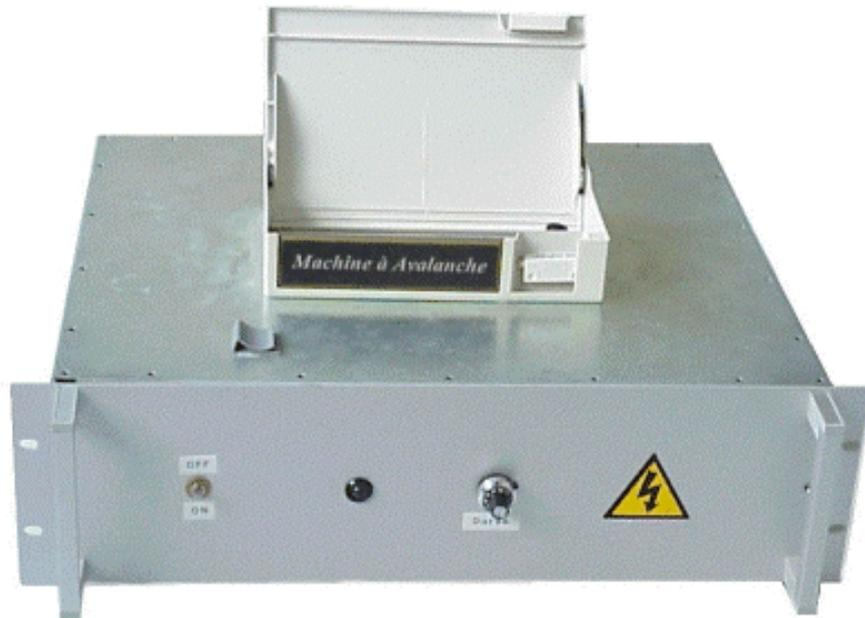
Figure VI.14 : Machine à Avalanche I ; 5 kV, 800 A
