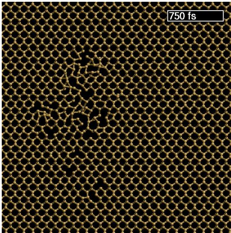
Figure 25: Modélisation des dégâts d'irradiation en cascade dans une matrice de silicium pur par dynamique moléculaire [42]
