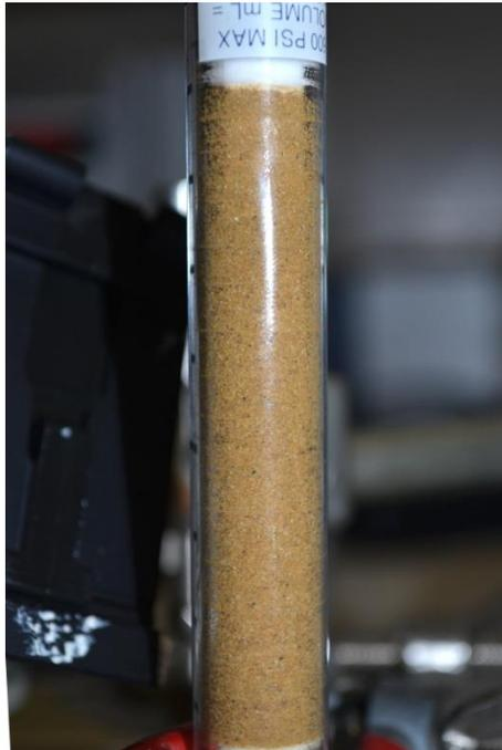
**Figure 25. Petite colonne de matériau BO10 saturé**
