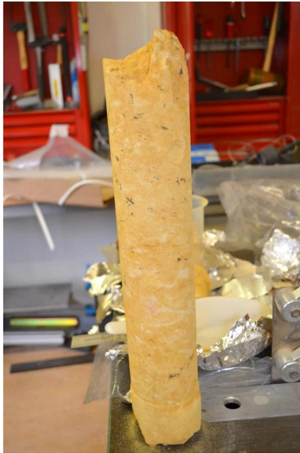
**Figure 13 : Carotte de sédiment BO10 après usinage**
