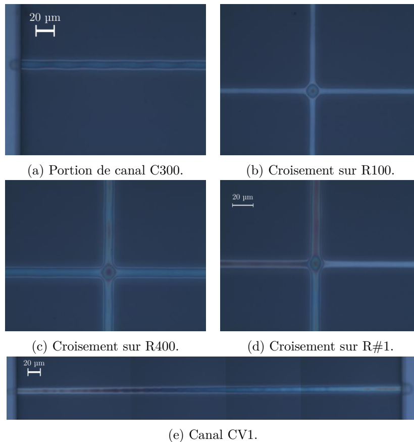
FIGURE 2.12 – Grossissement sur quelques puces du wafer L107. La couleur donne une indication de la profondeur.
