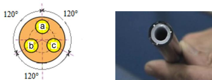
Figure 5.11 – Câble contenant trois fibres optiques pour la mesure des rayons de courbure [112 Maurin] ; Crédit Photo S. Magne ; Fabrication ACOME].
