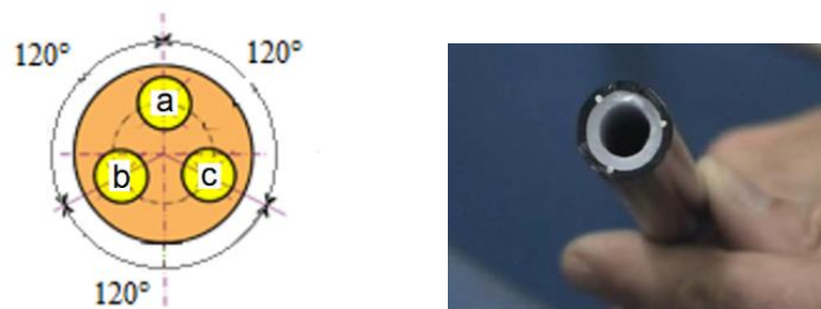
Figure 5.11 – Câble contenant trois fibres optiques pour la mesure des rayons de courbure [112 Maurin] ; Crédit Photo S. Magne ; Fabrication ACOME].
