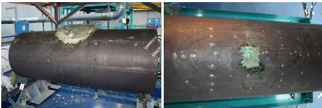
Figure 5.1 – Installation de test : sodium liquide au sommet à la fin d'expérience
