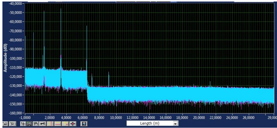
Figure 4.18 – Trace réflectométrique caractéristique d'un OFDR ; Appareil OBR Luna 4600
