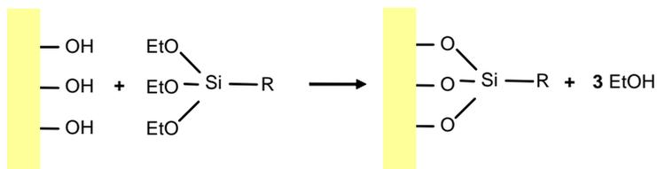
**Figure 4.5:** Schéma d'une réaction de silanisation. Les silanols en surface réagissent avec un organosilane tri-fonctionnel où EtO est le groupement fonctionnel pouvant réagir avec les silanol et R le groupement organique à fixer.
