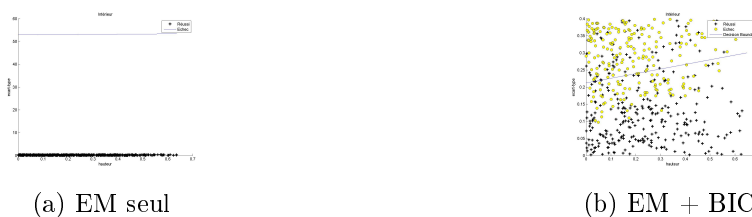
FIGURE 3.4 – Succès et échec d'un apprentissage correct de la topologie générée (simplexe plein de dimension 2). En abscisse, la plus petite hauteur du simplexe, en ordonnée l'écart-type avec lequel ont été générées les données. Pour un simplexe plein, l'algorithme EM seul est le plus performant avec 100 % de réussite. En effet pour un simplexe plein, il "suffit" de ne retirer aucun des composants. Le taux de succès du critère BIC est plus faible ( < 50\% ), ce qui montre que l'enveloppe d'un simplexe peut dominer l'intérieur de ce simplexe, même en utilisant le modèle qui a permis de générer les données.
