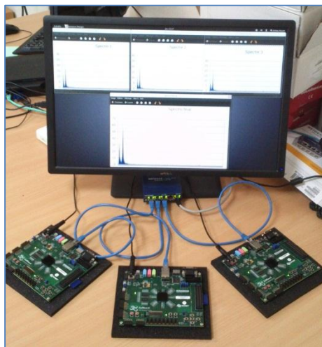
Figure 4-16 : Maquette de l'architecture équipée de trois ZedBoards.
