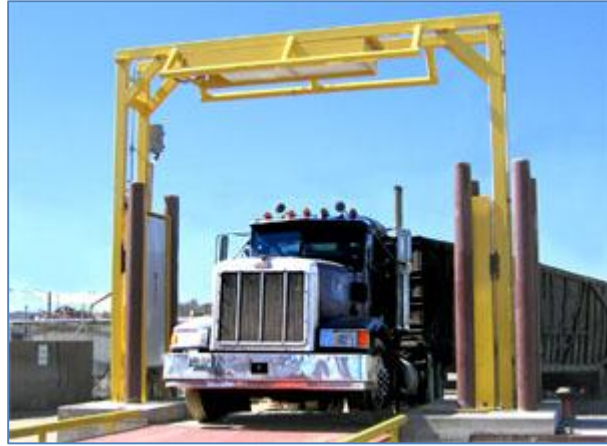
Figure 1-1 : Un portique de détection pour véhicules routiers.
