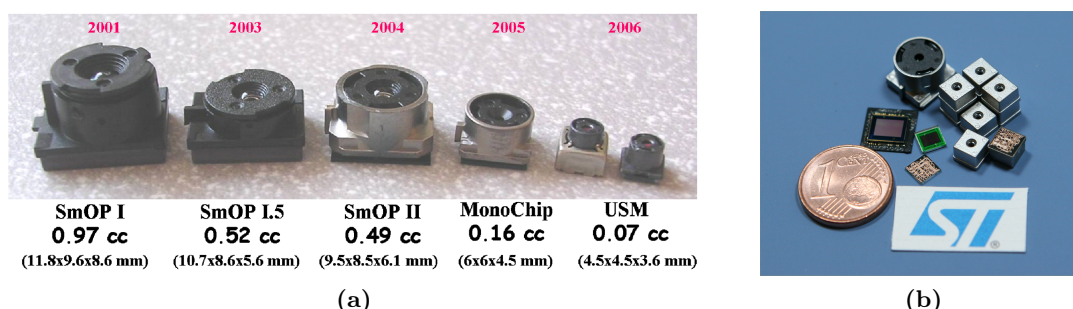
FIGURE 3.4 – Évolution de la taille des caméras miniatures : (a) pour un capteur de définition VGA (0.3Mpixel) entre 2000 et 2006, (b) pour un capteur 2Mpixels entre les générations de pixel 3\mu\text{m} et 1,75\mu\text{m} , source STMicroelectronics.
