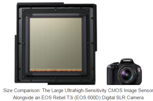
FIGURE 4.9 – Capteur 120Mpix de 20 \times 20\text{cm}^2 développé par Canon, comparé à un appareil reflex
