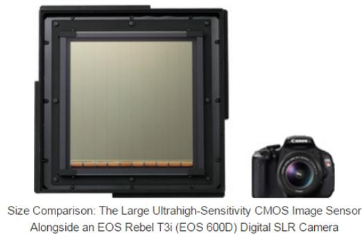
FIGURE 4.9 – Capteur 120Mpix de  $20 \times 20\text{cm}^2$  développé par Canon, comparé à un appareil reflex
