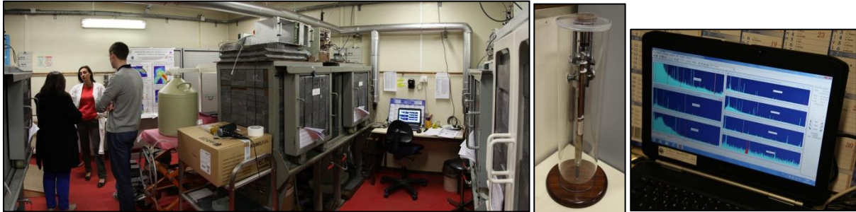
Figure 2. À gauche : Vue partielle de la casemate du LSCE à Gif-sur-Yvette où sont installés les spectromètres gamma ; au centre : cristal de germanium utilisé pour la détection des photons gamma ; à droite : système d'acquisition des spectres gamma sur micro-ordinateur. (Source : Unité de Communication du CEA Saclay.)
