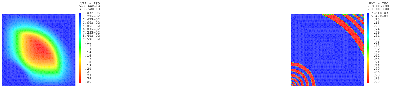
FIGURE 4.5 – Schéma EF (solution numérique et lieu des valeurs négatives) pour l'équation (4.19) et f discontinue : 38000 mailles, 12 % d'oscillations (valeur minimum : -9.44 \times 10^{-4} ).
