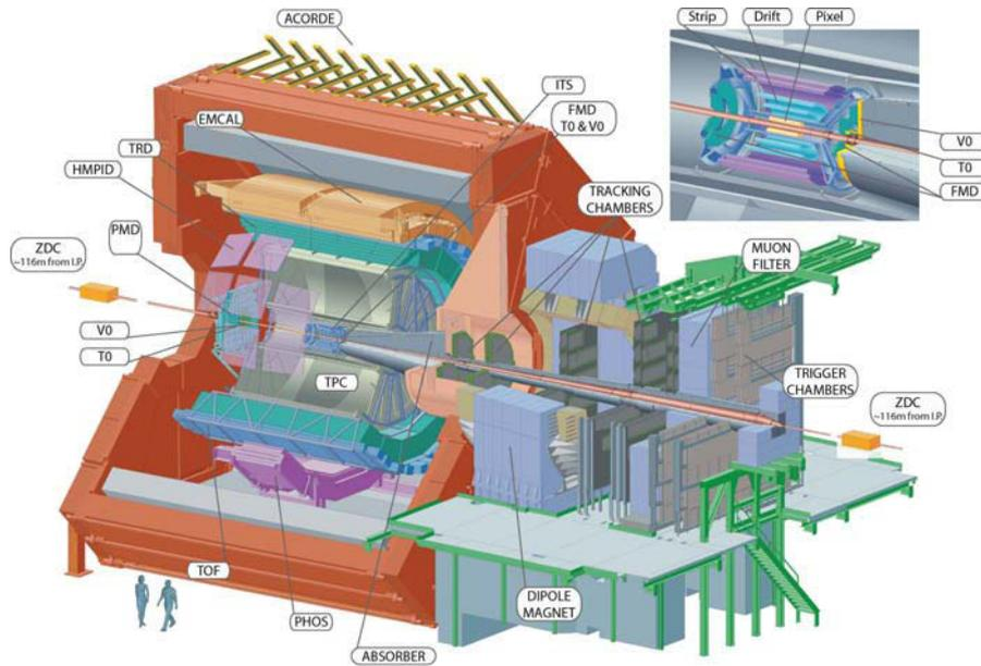
FIGURE 3: Schéma du détecteur ALICE.
