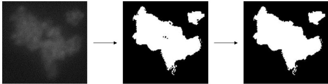
Figure 2.12 – Apparition de trous suite à la binarisation et leur remplissage
