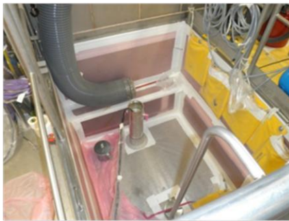
Figure 30 : Détecteur GeHP et son caisson installés en configuration de mesure
