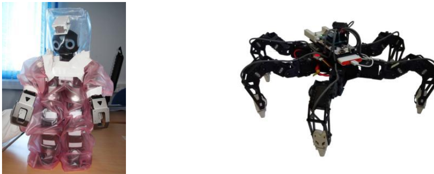
Figure 75 : A droite plateforme hexapode testée pour l'amélioration du franchissement (Phantom X [132]), à gauche la plateforme Darwin-OP [133] adaptée aux conditions opérationnelles de milieux fortement contaminé
