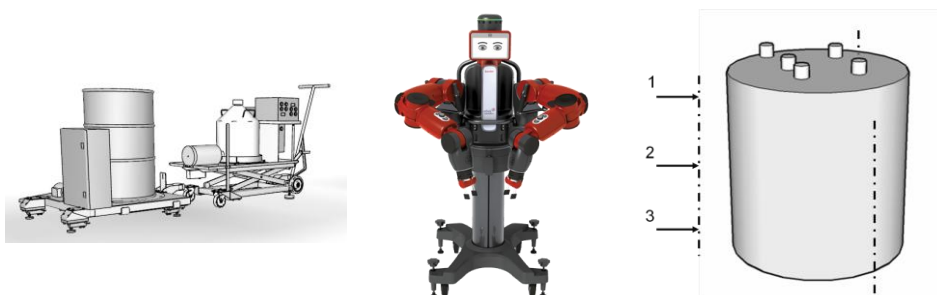
Figure 79 : De gauche à droite, une vue 3D d'un poste de caractérisation radiologique de colis de déchets équipé d'une détecteur de spectrométrie gamma, le Cobot Baxter [140] [139], un colis de déchets avec les repères de relevés de débit de dose sur trois génératrices placées à 120°
