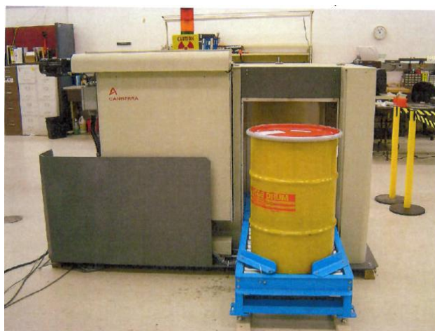
Figure 60 : Vue des postes de mesure neutronique au premier plan et le poste de spectrométrie gamma en second plan
