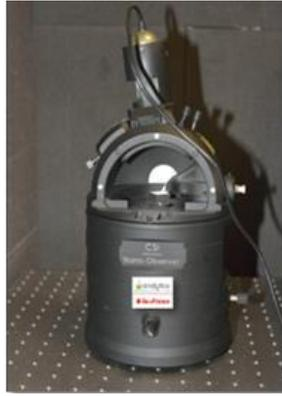
**Figure II-2 :** *Microscope à force atomique (CSI Instruments, Scientec, NanoObserver).*
