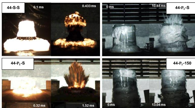
Figure 2. Images extraites d'enregistrements des essais 44-S-S, 44-P<sub>1</sub>-S, 44-P<sub>1</sub>-100 et 44-P<sub>1</sub>-150
