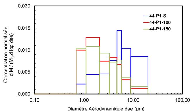
Figure 4. Distribution granulométrique de l'aérosol de  $WO_3$
