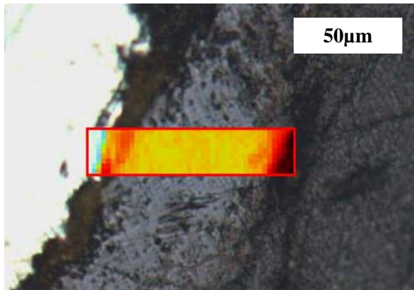
Couche isolante électriquement : interface métal/couche
