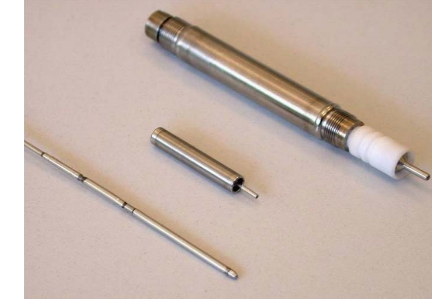
Chambre à fission miniature développée par DEN/DER/SPEX et Photonis
