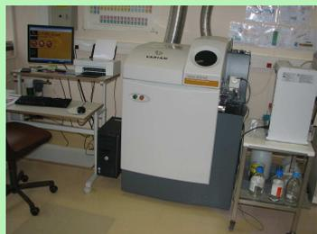
Micro-nébuliseur concentrique, chambre de nébulisation de type Scott refroidie à 3°C par effet Peltier, détecteur DDEM
