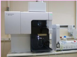
Nébuliseur Seaspray, chambre cyclonique, visée axiale, détecteur CCD
