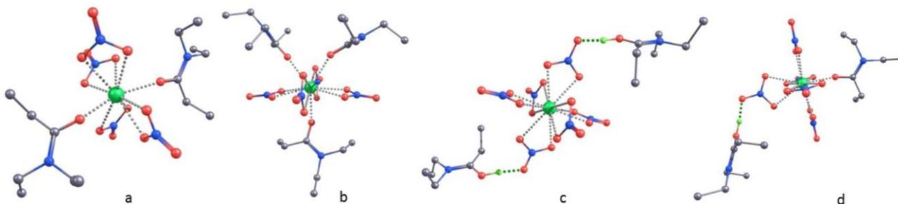
Figure 2 : Représentation schématique des complexes de Pu(IV) simulés - a :  $\text{Pu}(\text{NO}_3)_4\text{L}_2$ , b :  $\text{Pu}(\text{NO}_3)_4\text{L}_3$ , c :  $\text{Pu}(\text{NO}_3)_6(\text{HL})_2$ , d :  $\text{Pu}(\text{NO}_3)_5(\text{HL})\text{L}$  avec L = DEHBA ou DEHiBA
