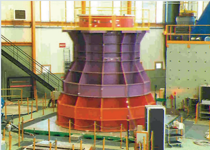
Maquette fluide-structure sur table vibrante
