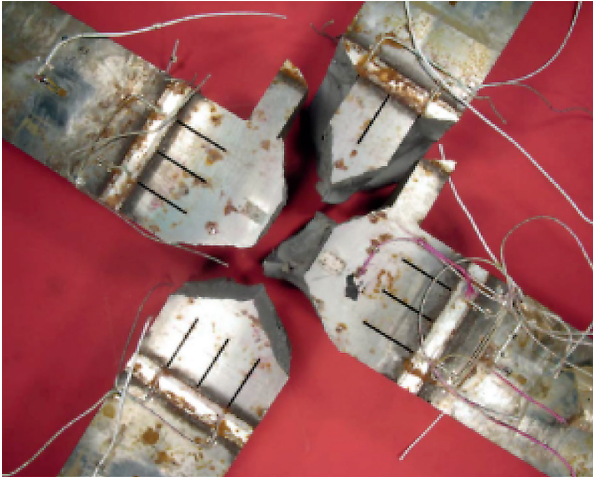
Fig. 29. Essais biaxiaux sur éprouvettes en croix dans le cadre de l'étude de la rupture fragile d'un acier de cuve en 18MnD5.
