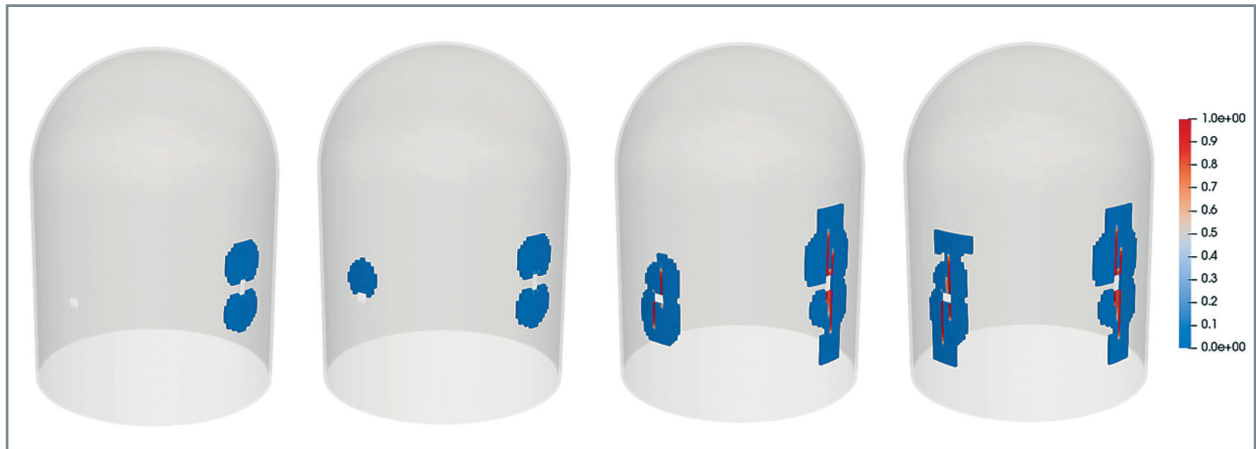
Fig. 132. Condensation statique adaptative appliquée à un modèle d'enceinte simplifiée sous chargement de pression au-delà de la pression de dimensionnement. Évolution de la distribution d'endommagement. Les zones grisées sont les zones condensées [9].
