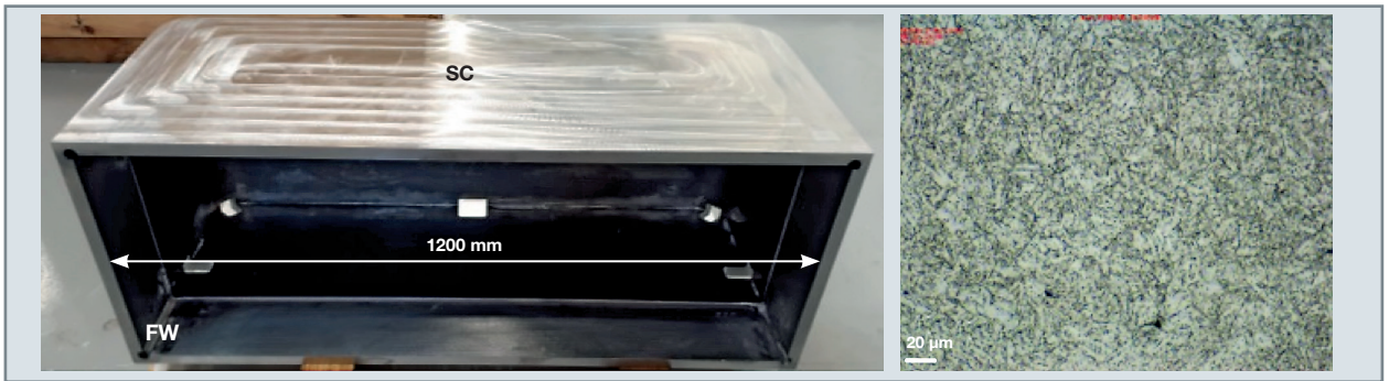
Fig. 254. Assemblage SC/FW après CIC et usinage (enlèvement du container).
