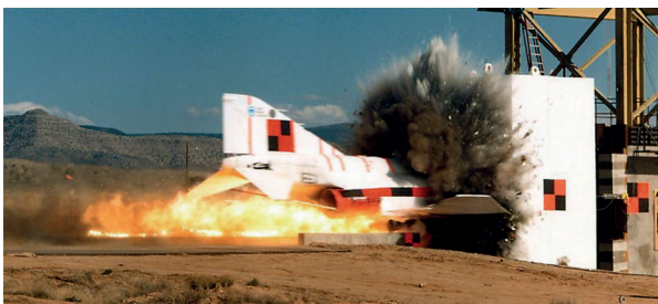
Fig. 190. Impact à 215 m/s d'un F-4 (19 t) contre un bloc de béton de 469 t posé sur coussin d'air [23].
