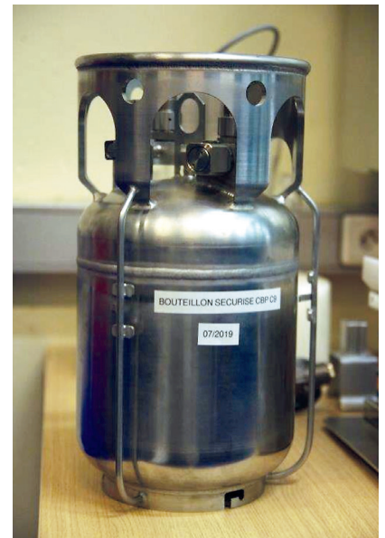
Fig. 234. Bouteillon sécurisé de l'installation ATALANTE.
