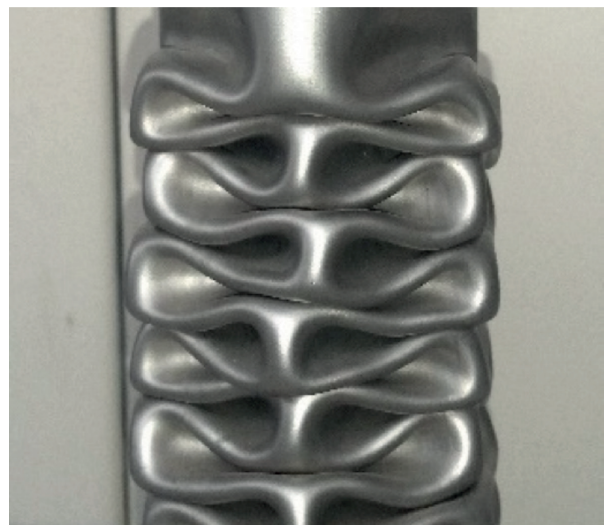
Fig. 176. Contacts multiples lors d'un impact sur un tube.
