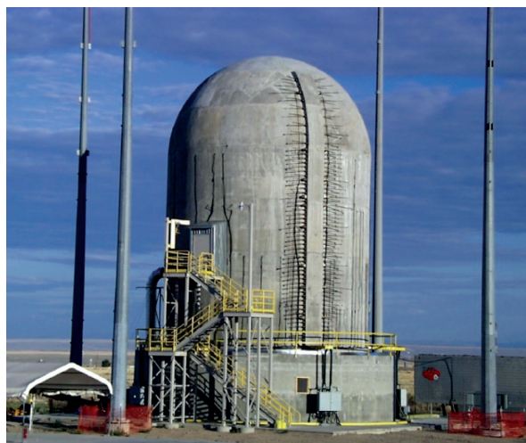
Fig. 140. Exemples de maquette d'enceinte de confinement. Maquette SANDIA (à gauche) [35] et VERCORS (à droite).
