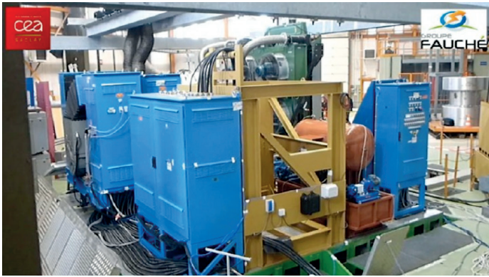
Fig. 276. Dispositifs d'amortisseur antisismique testés sur la plateforme TAMARIS.
