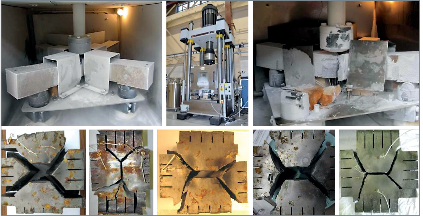
Fig. 113. Essais WPS sous chargement biaxial : éprouvettes cruciformes du CEA en fin d'essai démontrant un mode de rupture reproductible quel que soit le cycle de chargement.
