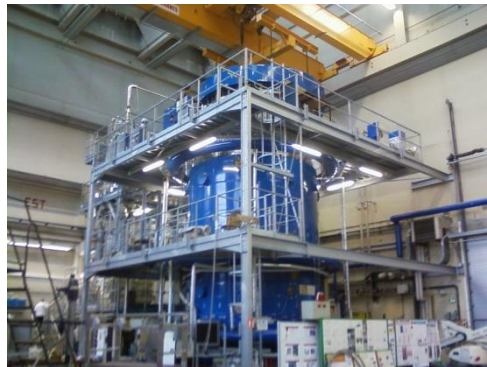
😊 SA thermodynamic conditions MISTRA, CEA [4,2 bar, 130°C, 100%RH]
