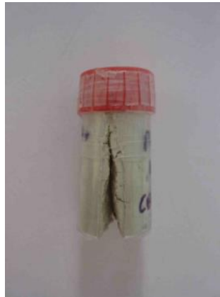
Figure 3 : Illustration de l'expansion des enrobés de REI : Eprouvette dilatée après solidification
