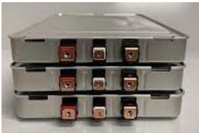
Modules batteries EV 60 Ah à l'état neuf
