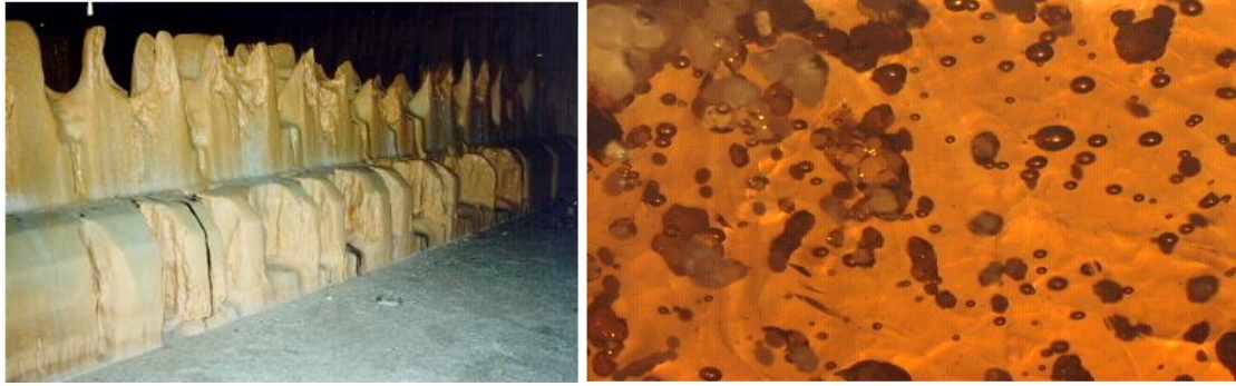
Fig. 1: A gauche, mur de réfractaires dans un four verrier en cours de réparation. Par rapport à leur état initial, les pièces réfractaires ont été très corrodées, c'est-à-dire qu'elles se sont en partie dissoutes dans le verre. A droite, visualisation à la loupe binoculaire d'un verre partiellement élaboré : il reste dans le liquide des bulles et des grains de sable "infondus", dont la dissolution par diffusion nécessite du temps et des hautes températures (champ de vue d'environ 2 mm).
