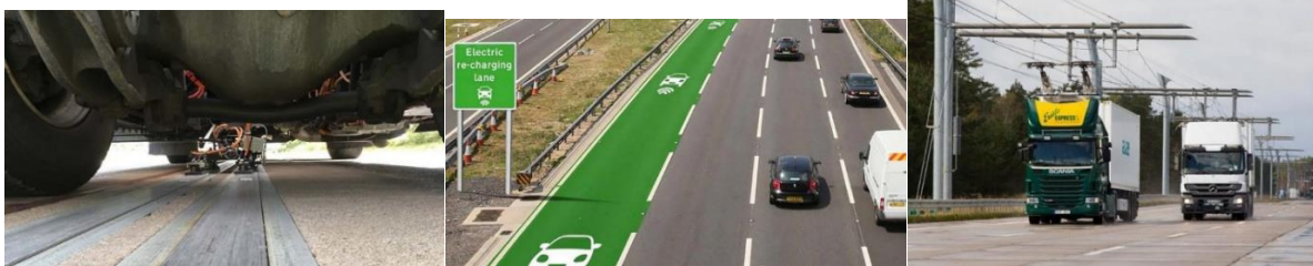
Figure 6 : Trois technologies de route électrique : Alimentation par le sol (Alstom), induction (Electreon Road), et caténares (Siemens)
