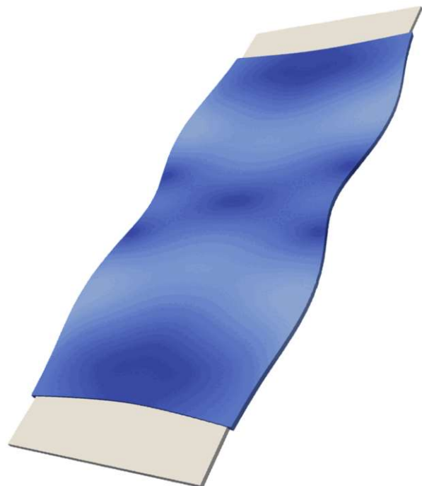
Figure 3: Snapshot du procédé d'estimation. En gris, la plaque est représentée dans sa déformation cible. En couleur, une estimation partielle faite en arrêtant le procédé d'estimation avant sa fin.
