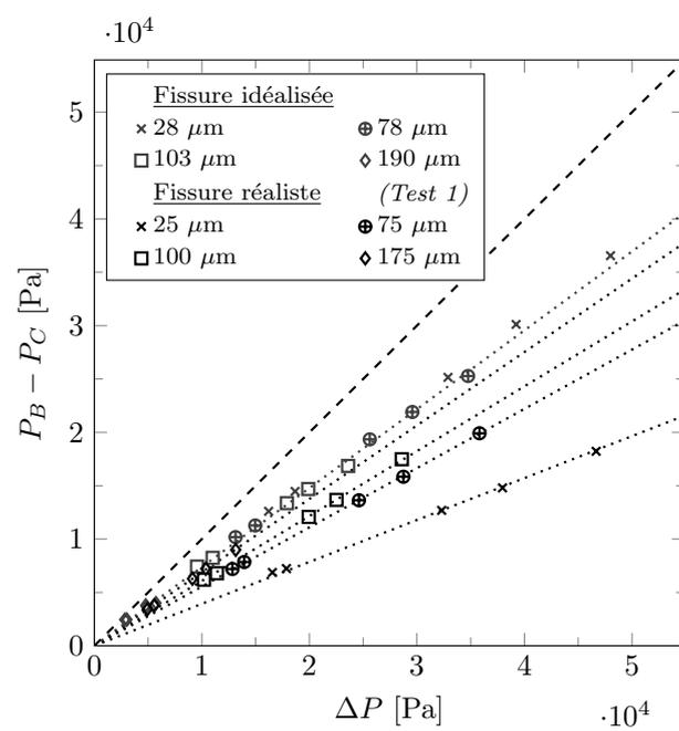
FIGURE 8 – Courbes  $P_B - P_C$  vs.  $\Delta P$ . La relation entre ces deux différentiels de pression illustre les pertes de charges cumulées entre l'entrée et la sortie de la fissure.
