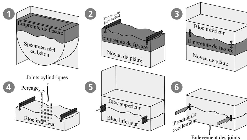
FIGURE 1 – Étapes de la fabrication des éprouvettes.
