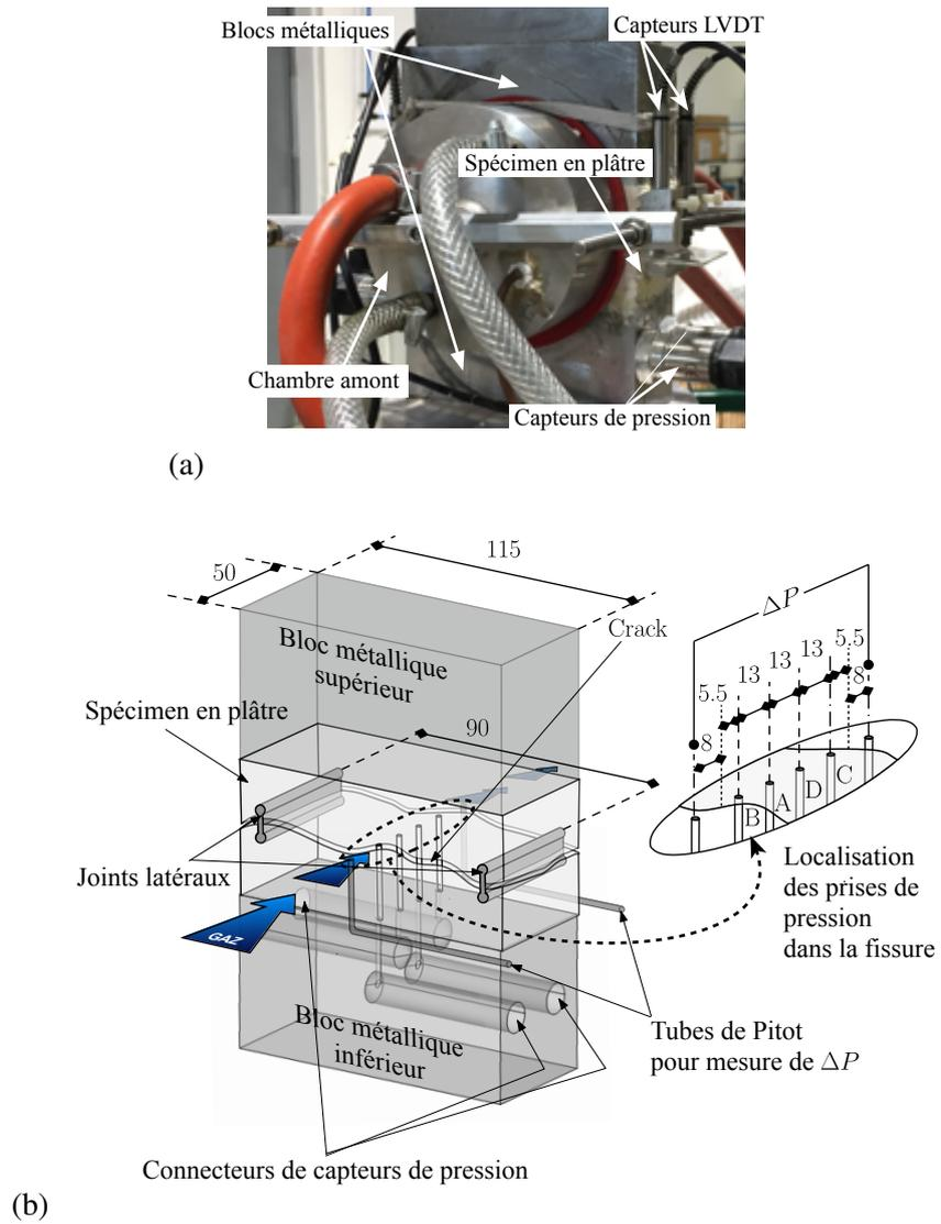
FIGURE 2 – Dispositif expérimental.
