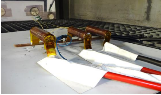
Figure 6 : essais de trois accumulateurs en parallèle en surcharge
