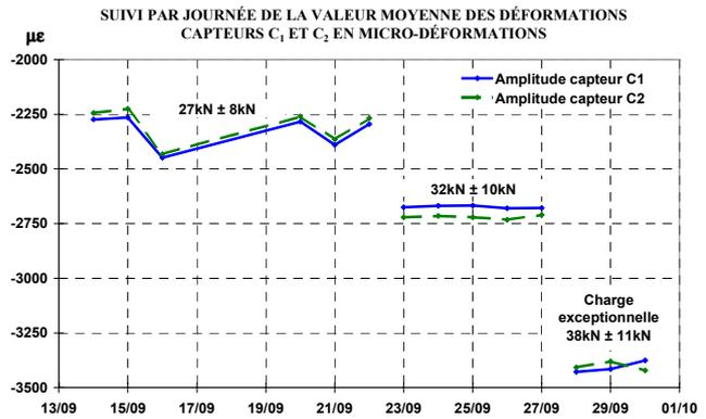
figure 6 : Suivi des déformations dans le temps
