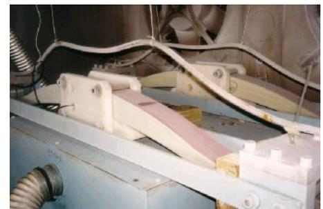
**Figure 14.** La lame instrumentée dans le banc d'essais climatiques
