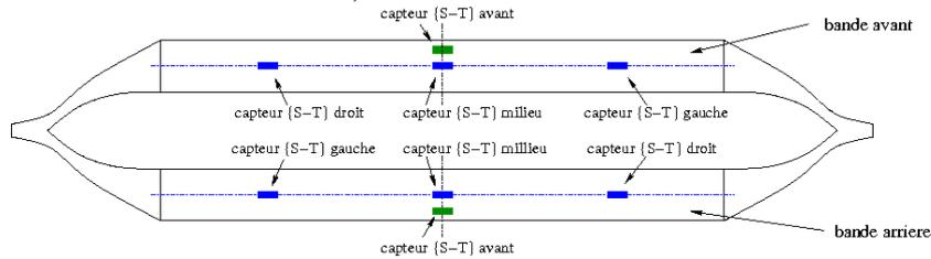
Figure 1. Position des capteurs à réseaux de Bragg dans la tête de pantographe modèle CX25 (vue de dessous)
