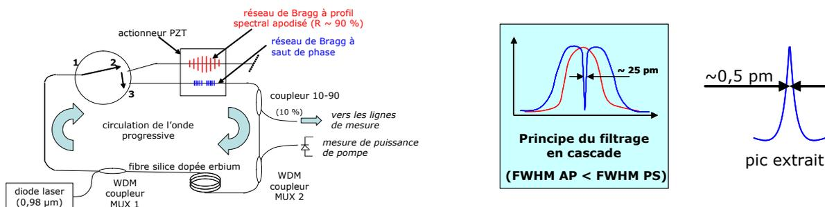
Figure 3. Principe du laser en anneau accordable développé par le CEA LIST.
