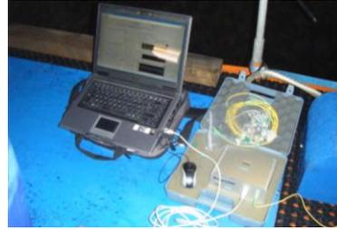
**Figure 6.** *Système compact monocanal BraggLight pour le contrôle de terrain*
