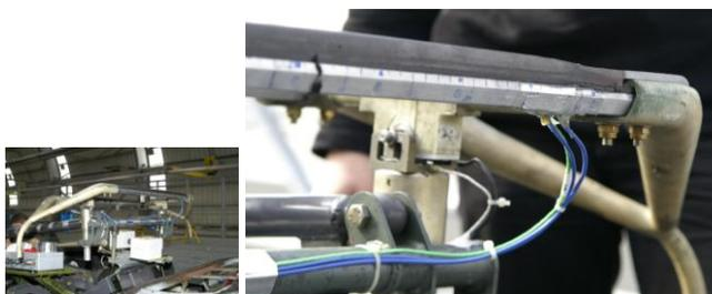
**Figure 1.** *Pantographe instrumenté, avec vue de détail des câbles à fibre optique*
