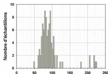
**Figure 7.** *Histogramme des déformations moyennes d'une section de ligne de contact obtenu à partir de mesures sur des trains franchissant le portique*
