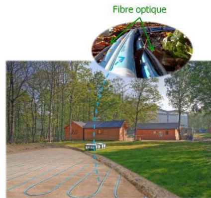
Figure 20 Vue d'artiste d'un échangeur horizontal en sub-surface équipé de fibres optiques (BRGM)
