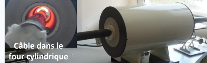
Câble de sécurité après 2 h à 750°C
