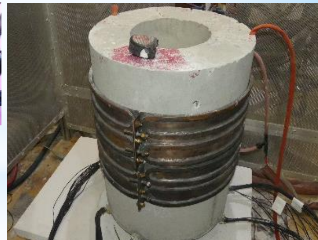
Creuset en béton équipé + boucle inductive
