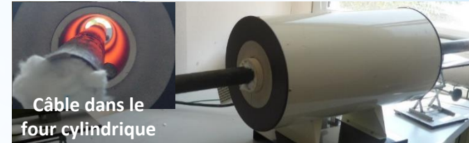
Câble de sécurité après 2 h à 750°C
