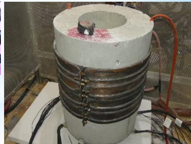
Creuset en béton équipé + boucle inductive
