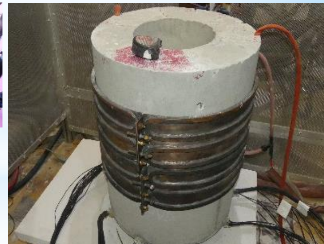
Creuset en béton équipé + boucle inductive
