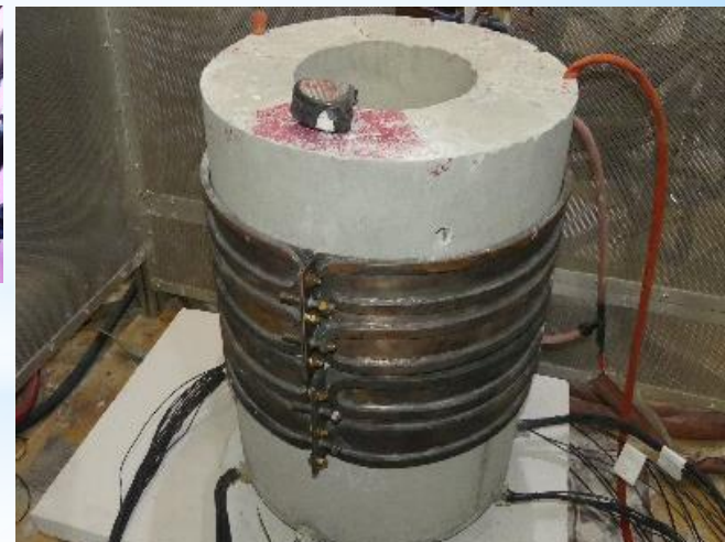
Creuset en béton équipé + boucle inductive
