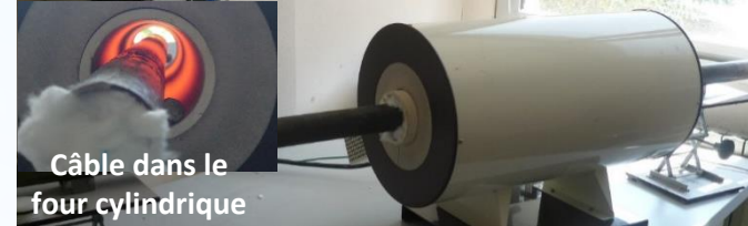
Câble de sécurité après 2 h à 750°C
