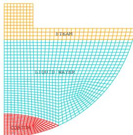
Figure 9: The ”**BOTTOM**” mesh
