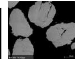
Image MEB coupe de grain de poudre IN718 2 +Y2O3 X1000
