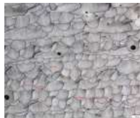
Image optique bains de fusion INCO718
