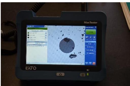
**Figure 8 : Sonde avant nettoyage**
